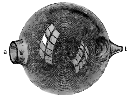
Figura B.1: Resonador de Helmholtz [79, Fig. 16 a].
